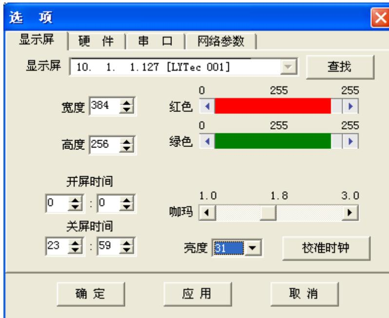
在這個介面裏，按下[校準時鐘]按鈕，可以根據電腦的系統時間校準顯示幕上的時鐘。
